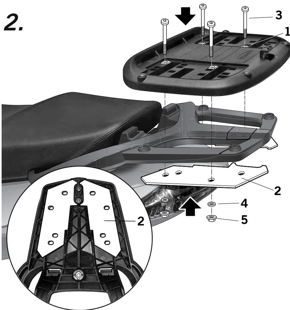
**(E)** Colocar los tacos rojos (1) sobre la parrilla de la maleta (ver colocación exacta en el dibujo) y montarla conjuntamente con las chapas bridas (2). Fijar todo el conjunto mediante los tornillos (3), arandelas (4) y tuercas (5).
